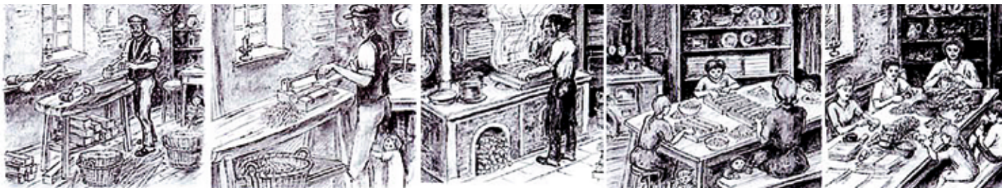
Manuelle Zündholzproduktion in Heimarbeit: Phosphor wird in einer Pfanne erhitzt (Archiv Schweizerisches Zündholzmuseum Schönenwerd)
