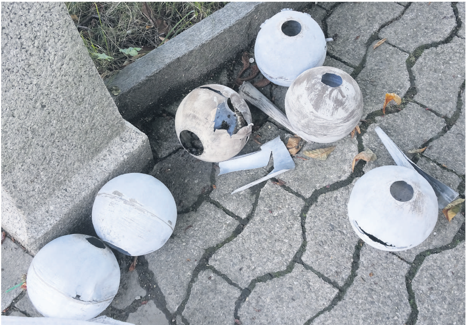
Durchgerostete Kugelspitzen nach der Demontage. (Beat Meier, 2017)
